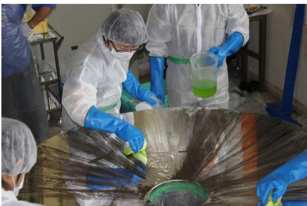
図2: 鏡の洗浄。古いアルミがはげてガラスの表面が見えています
