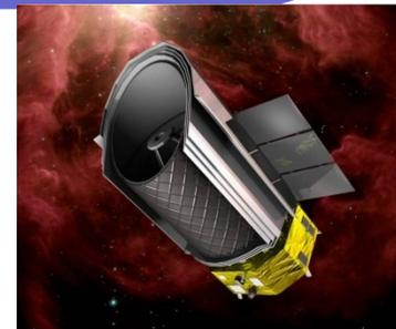
口径3.2m冷却望遠鏡搭載
